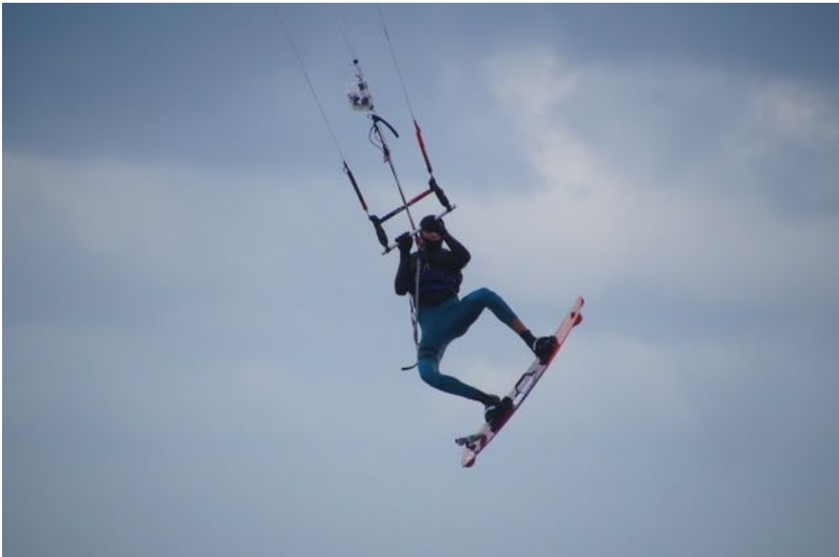
Afbeelding 67: sprong met twin-tip board waarbij goed het dubbel barsysteem, de 3 krachtmeters en de laserlamp zichtbaar zijn
