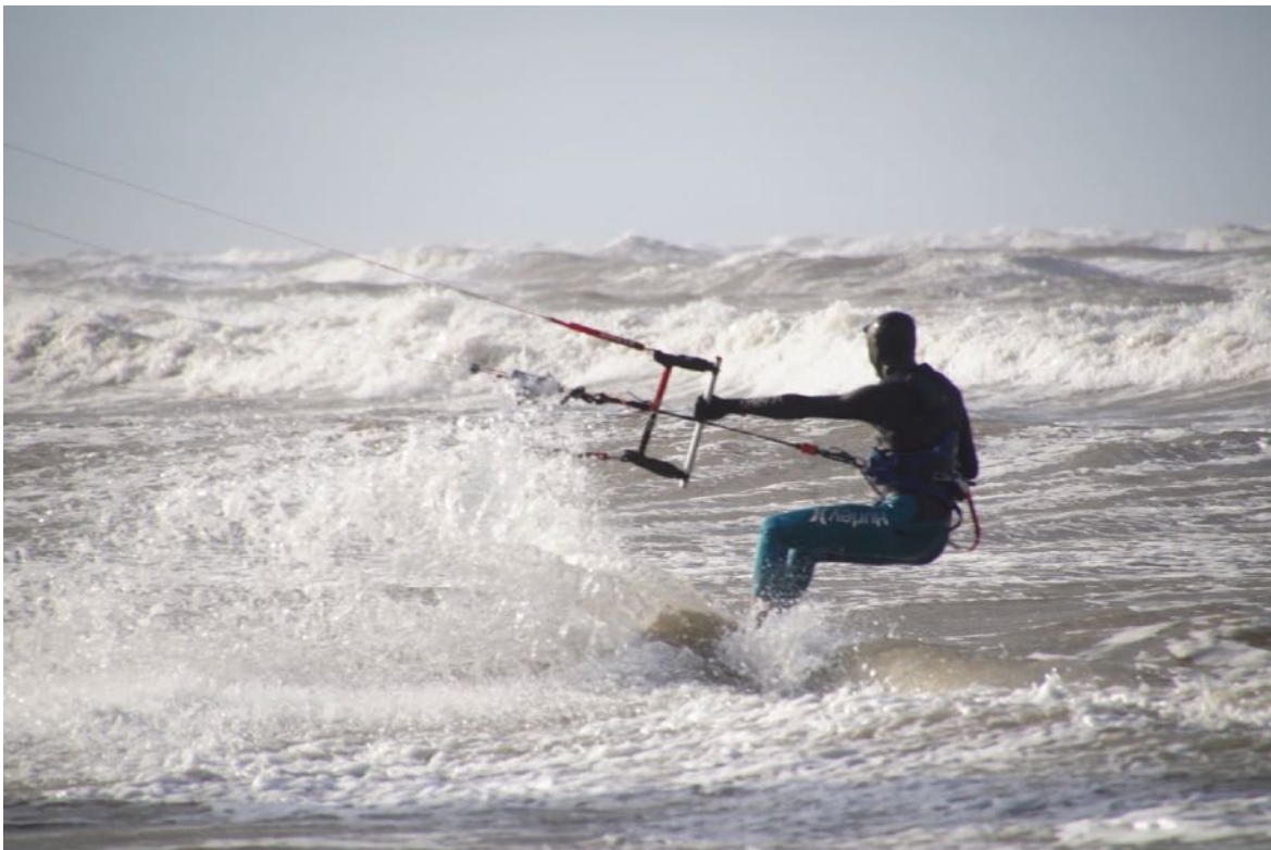
Afbeelding 69: November 2017: Verzamelen van data met het dubbele barsysteem voorzien van krachtmeters.
